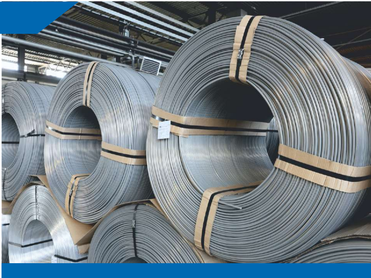
Катанка из алюминиевого сплава ТУ 16-705.493-2006
